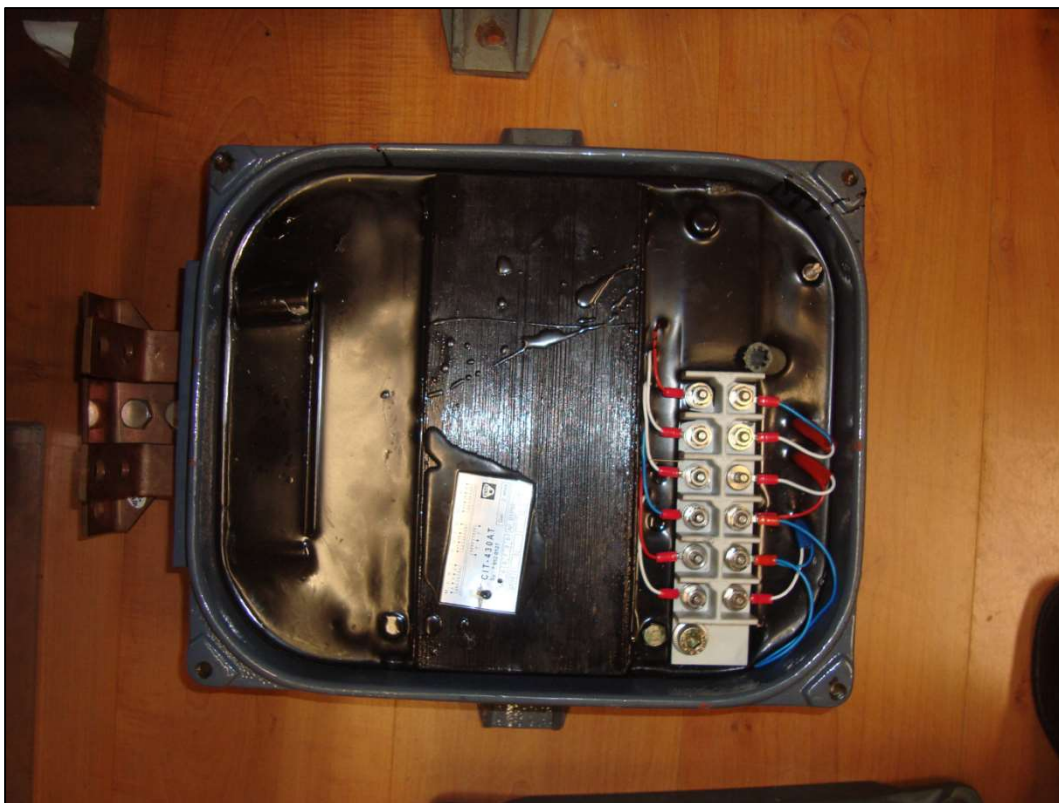
Figura 24 – Caixa de impedância com preenchimento em resina.
