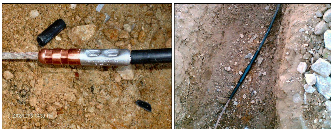
Figura 4 – Ligador bimetálico (à esquerda, antes da colocação da manga; à direita, depois da colocação da manga)
